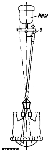
Bild 3. Vakuumdichte Laboratoriums- Rührapparat
